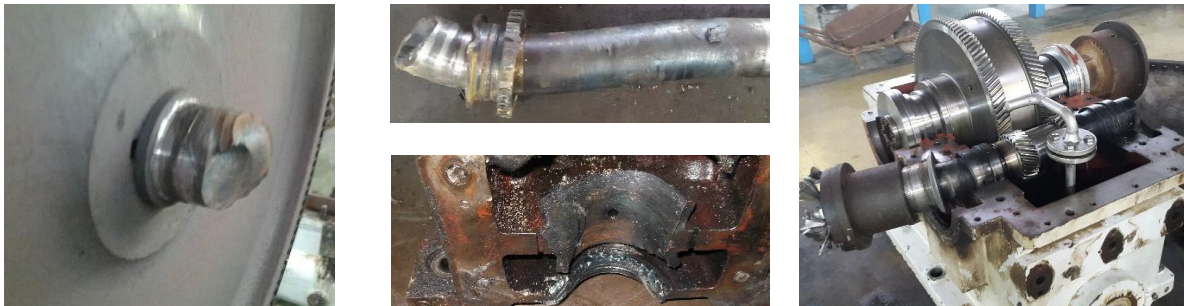
شکل ۱۳. محور توربین و محور چرخ‌دنده محرک جعبه‌دنده
