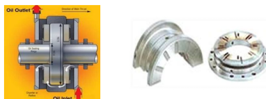
شکل ۵. بیرینگ لغزشی محوری و تشکیل فیلم روغن در آن
