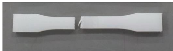
شکل ۱۹. نمونه تست کشش اتصال [۲۱]
