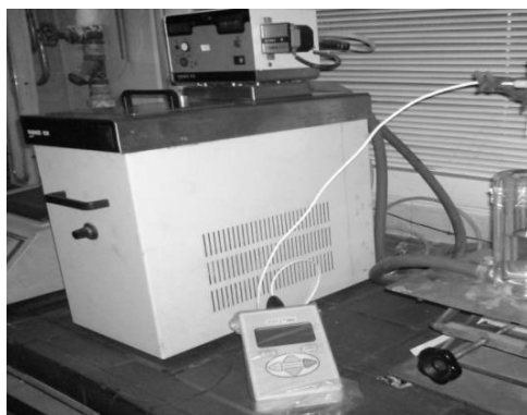
شکل ۳. تصویری از نحوه قرار گرفتن دستگاه KD2 و سیرکولاتور
