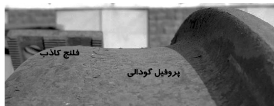
شکل ۴. سایش گوردالی در سطح چرخ مربوط به سالن مسافری با سیستم ترمز کفشکی که سبب ایجاد فلنج کاذب در سمت خارجی چرخ شده است
