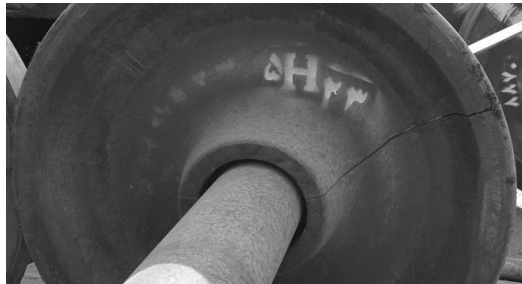
شکل ۱۵. ترک عرضی حرارتی که در عرض سطح چرخ و در امتداد محور ایجاد شده و در جان چرخ به صورت کامل رشد کرده است
