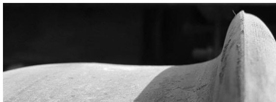
شکل ۵. سایش شدید سطح داخلی فلنج و ایجاد برآمدگی روی آن
