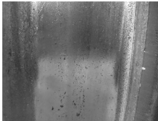
شکل ۹. مراحل اولیه شکل گیری باند ترک در ناحیه دوم در مجاورت فلنج برای یک نوع واگن مسافری که در مسیر تهران-مشهد سیر می کند
