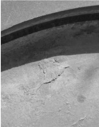
شکل ۱۴. چرخ بیش گرم شده دچار جداشدن لایه رنگ از سطح آن
