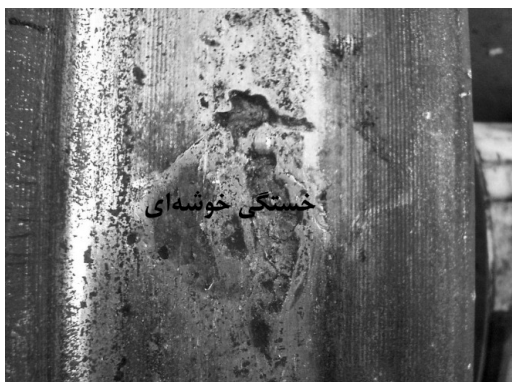
شکل ۱۱. خستگی خوشه‌ای ناشی از تماس غلتشی چرخ یک سالن مسافری با سیستم ترمز کفشکی
