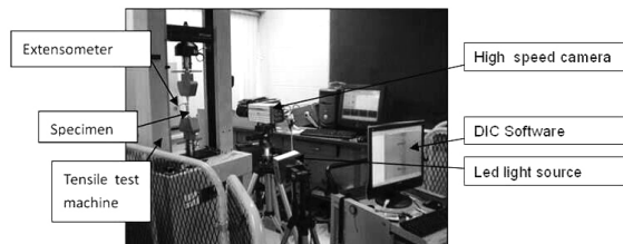
شکل ۱۰. تجهیزات مورد نیاز روش DIC
