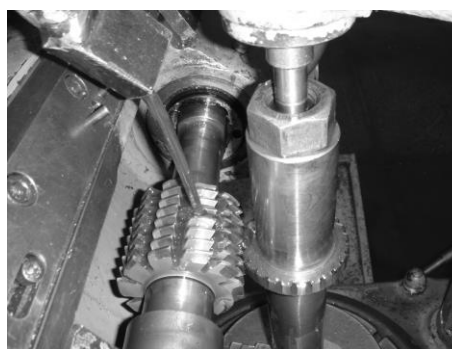
شکل ۵. تولید چرخ‌دنده ساده با نانو روانکار آلومینا در دستگاه هاب
