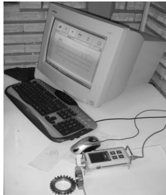
شکل ۷. نحوه سنجش مقادیر زبری سطح چرخ‌دنده‌های ساده
