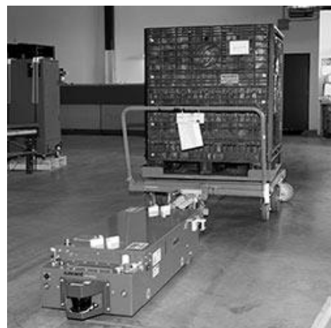
شکل ۱. یک خودروی هدایت خودکار چندمنظوره در حال کشیدن پالت بار
