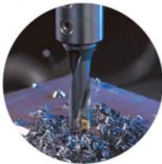
شکل ۴. ماشینکاری فولاد تولاکس [۷]
