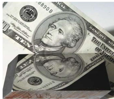
شکل ۸. نمونه‌ای سطح تمام‌شده نهایی از فولاد تولاکس [۱۰]
