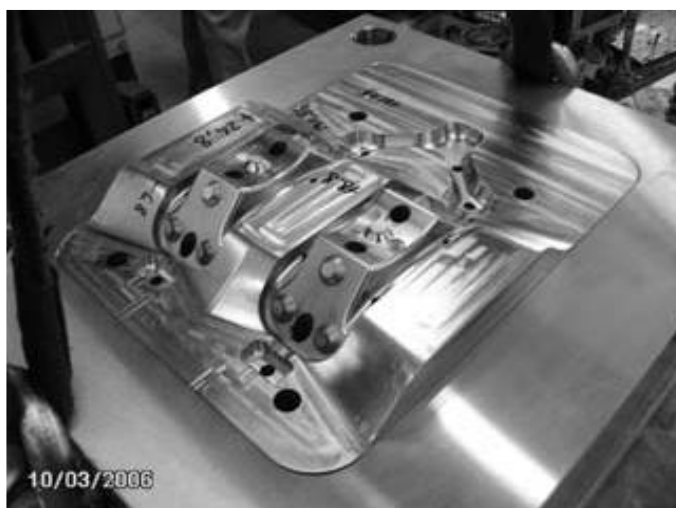
شکل ۱۱. تولید قالب دایکست از فولاد تولاکس ۴۴ [۱۲]
