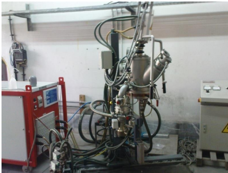
شکل ۳. دستگاه ریخته‌گری کوره ذوب قوسی تحت خلأ مورد استفاده در ریخته‌گری
