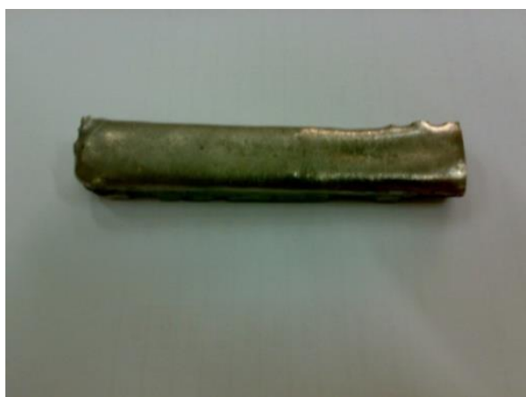
شکل ۹. یک شمش ریخته‌گری شده \gamma -TiAl جهت عملیات ماشینکاری
