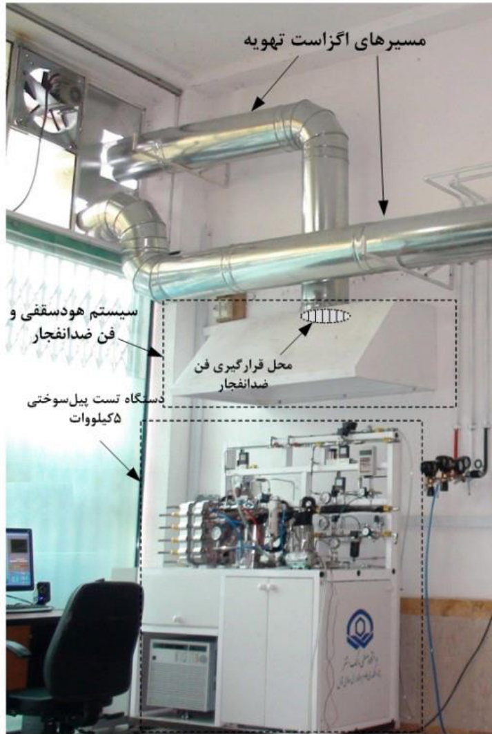
شکل ۳. نحوه جانمایی سیستم هود سقفی و فن ضدانفجار روی دستگاه تست ۵ کیلووات پیل سوختی هیدروژنی
