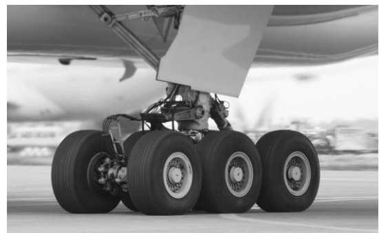
شکل ۱. ارابه فرود بوئینگ ۷۷۷ به‌همراه درپوش کامپوزیتی آن
