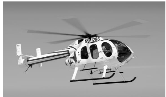
شکل ۶. هلی‌کوپتر ام. دی. ۱۶۰۰. مجهز به سیستم نوتار
