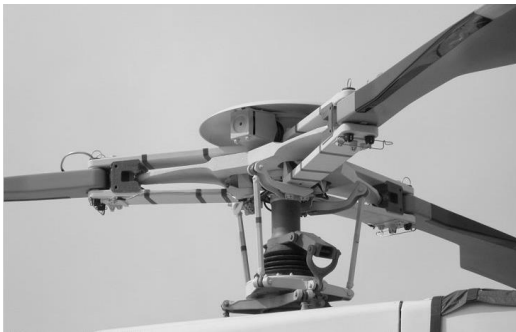
شکل ۷. نمایی از تویی پروانه ساخته‌شده از مواد مرکب
