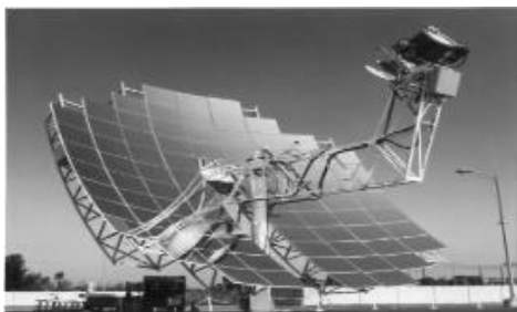
شکل ۵. کلکتور سهموی بشقابی [۶]
