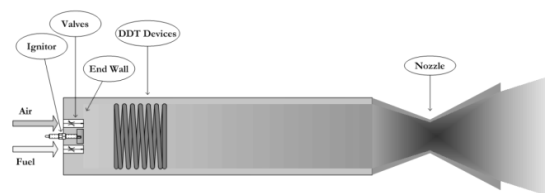
شکل ۵. نمایش شماتیک یک موتور انفجار ضربه‌ای ساده [۱۸]
