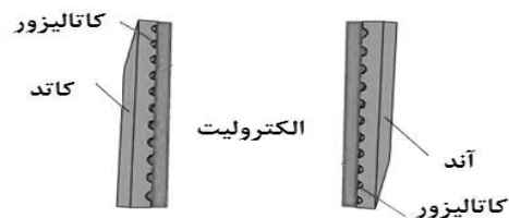
شکل ۶. نحوه قرارگیری کاتالیزور
