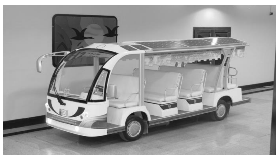
شکل ۳. نمایی از خودرو هیبریدی پیل سوختی دمابالای دانشگاه ولی عصر (عج)
