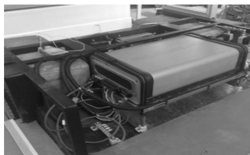
شکل ۲. نمایی از پیل سوختی دمابالای مورد استفاده در خودرو هیبریدی
