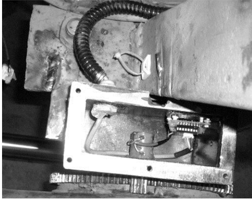
شکل ۱۱. باکس حسگر شیب لحظه‌ای با چرخ‌دنده‌ها و ولوم
