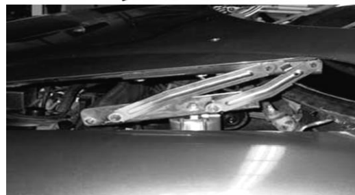
شکل ۶. سازوکار الکتریکی-مکانیکی محرک سیستم بالابرنده درب موتور
