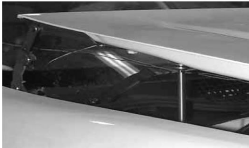
شکل ۵. سازوکار سیلندر - پیستون مورد استفاده در سیستم بالابرندۀ درب موتور در خودروی هوندا
