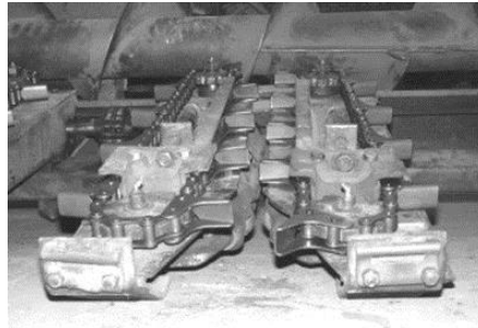
شکل ۹. مونتاژ سازوکار زنجیر روی شاسی واحد خوراک‌گیر
