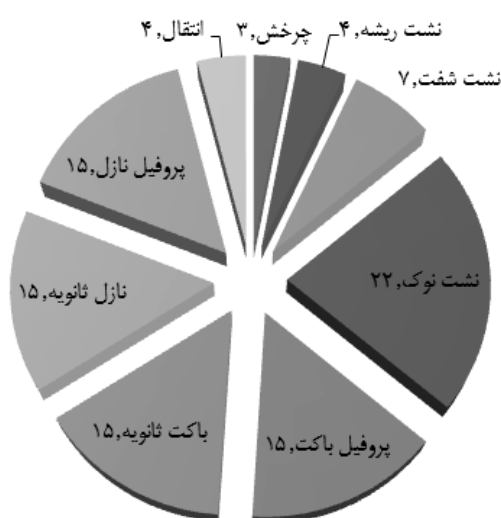
شکل ۶. افت‌های معمول در قسمت پرفشار توربین [۱۱]
