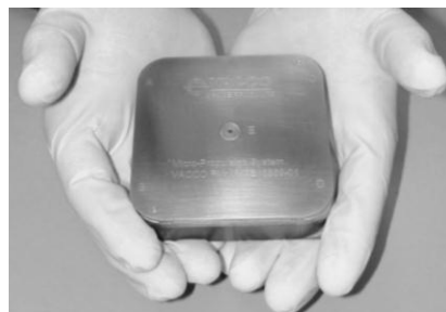
شکل ۸. یک میکروپیشراشه گاز سرد بر گرفته از وبگاه شرکت وکو
