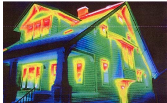
شکل ۱۸. نمایش اتلاف حرارتی با استفاده از یک آشکارساز [۱]
