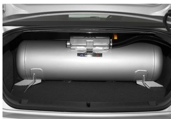
شکل ۴. نمای از یک مخزن ال. پی. جی. در خودرو
