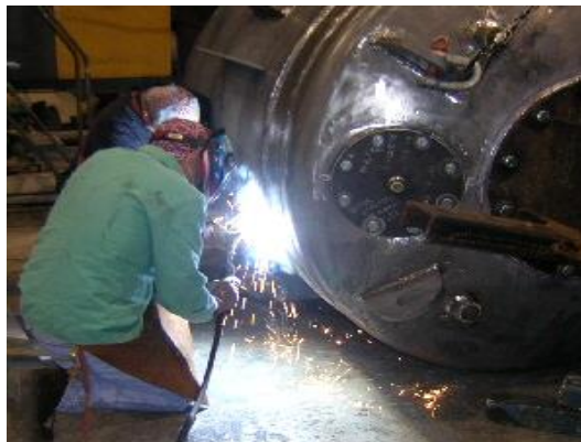
شکل ۱. روش جوشکاری در ساخت مخازن تحت فشار
