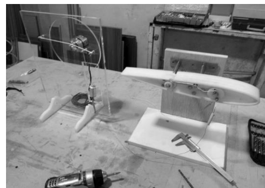
شکل ۱۶. نمونه مدلسازی شده با جرم و فنر
