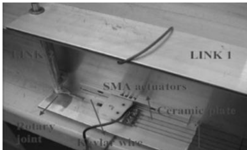
شکل ۹. سازه و سازوکار عملگر طراحی‌شده روی و همکاران
