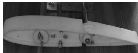
شکل ۱۵. پروفیل مقطع بال طراحی شده با فنر بازگشتی
