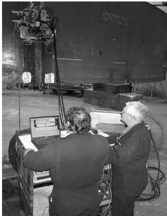
شکل ۱۴. تصویر اسکنر با چرخ مغناطیسی و فرایند بازرسی آن
