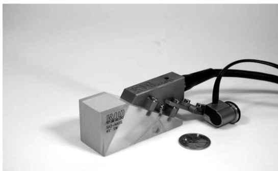
شکل ۱۰. یک پروب آرایه فازی همراه با یک انکدر کوچک
