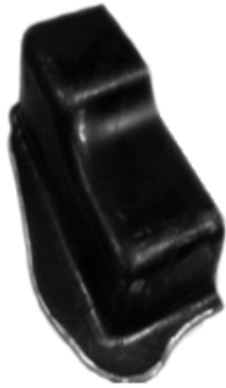
شکل ۱۴. قطعه کنار پله‌ای با ارتفاع پله ۱۰ میلی‌متر در فشار ۴۰ مگاپاسکال، به‌دست آمده از تست آزمایشگاهی
