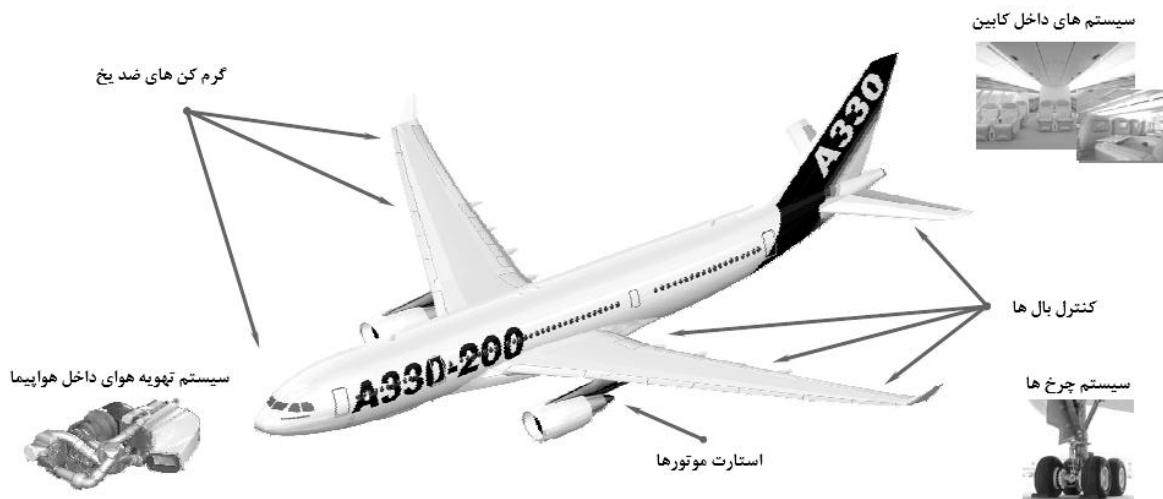
شکل ۲. مصرف‌کننده‌های اصلی واحد توان کمکی هواپیما
